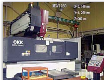
新規設備機種/ MCV-1260 X=2,140mm、Y=1,260mm、Z=900mm
