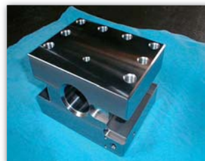
フライス、マシニング加工例 (中心穴と溝との割芯度0.01以内)
