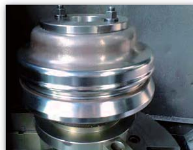
立旋盤による加工例 (フォーミングローラーの外形修正)
