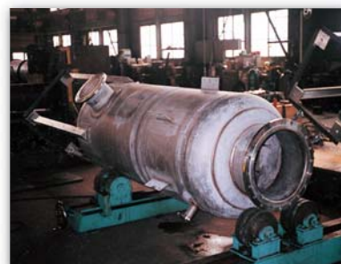
ステンレス製圧力容器 φ1200×2500L
