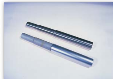
チタン合金(フェロチタニウムC) メッキ前(上) メッキ後(下)
