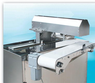
高速ハンドリング装置 ゾル・ゲル状ワークを形を崩さず、高速にハンドリングできる装置（2009年6月発売）
