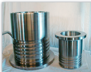
工作機械主軸用ベアリング冷却用スリーブ 旋削加工例(ラセンのピッチ22mm、溝幅12mm)
