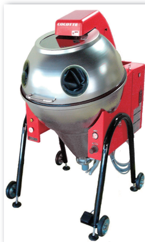
バイク・自動車部品表面処理用ウェットブラスト装置ココット
