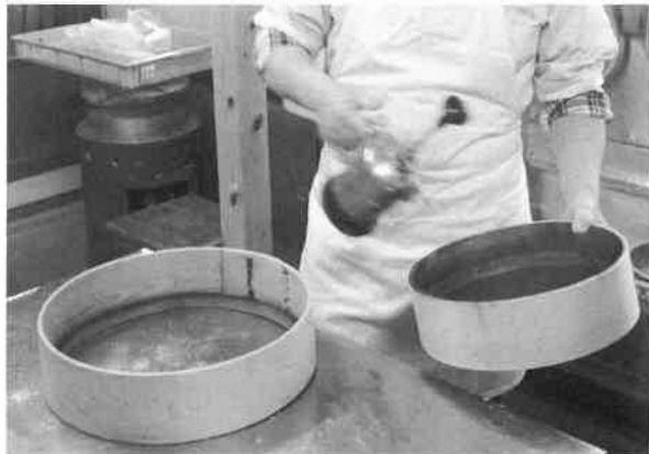
写真2 霧吹きで水を吹き付けて毛網を湿らせる
