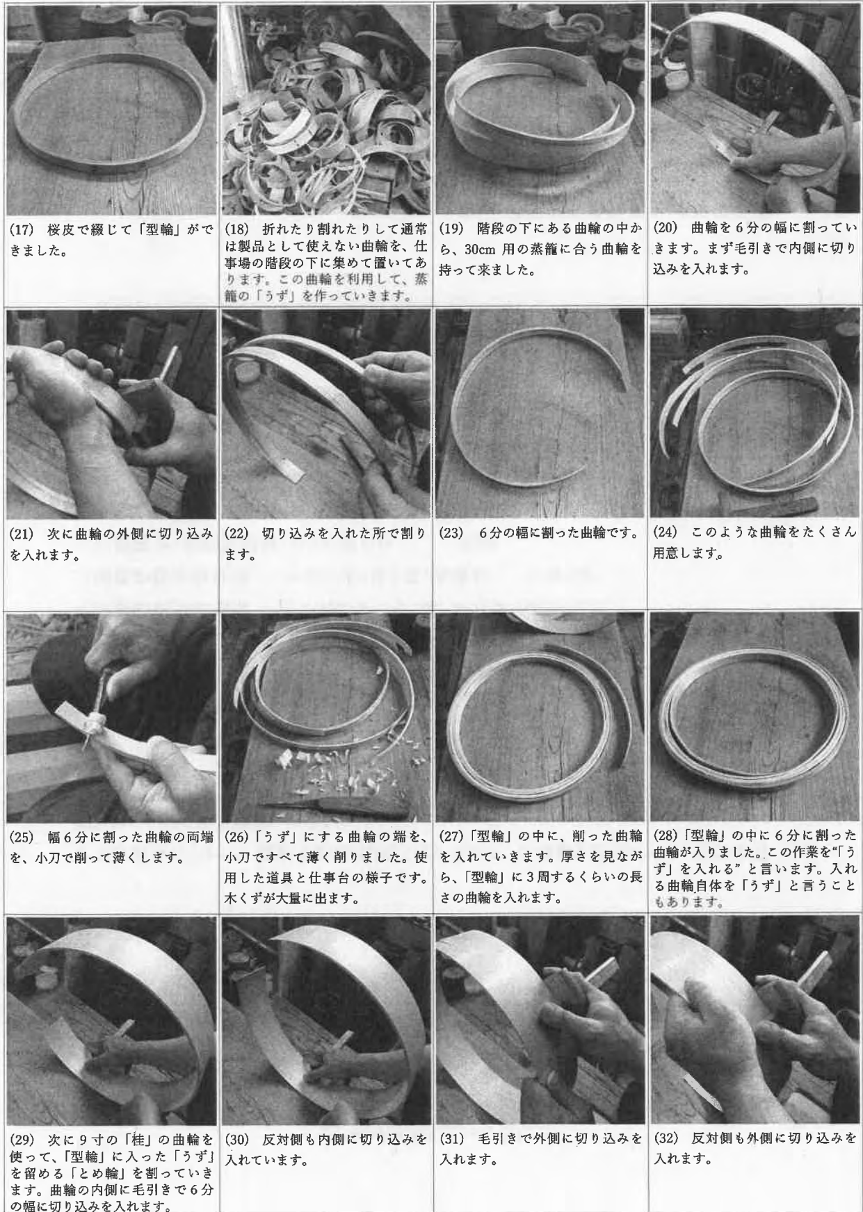
図10 30cm用の蒸籠の製作(2)
