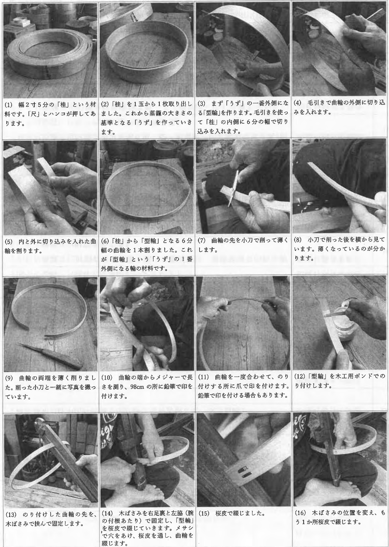
図9 30cm用の蒸籠の製作(1)
